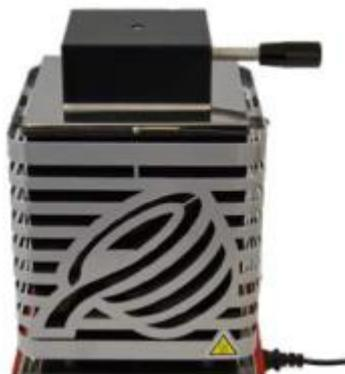
Чтобы включить печь, поверните выключатель питания в положение “I” (ON) и убедитесь, что горит индикатор, указывающий на наличие электрического напряжения.
