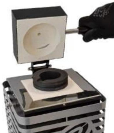
Используя прилагаемые щипцы или аналогичный инструмент, возьмите тигель за выступ (верхний край) и перенесите его в емкость или форму, в которую будет заливаться расплавленный металл.
