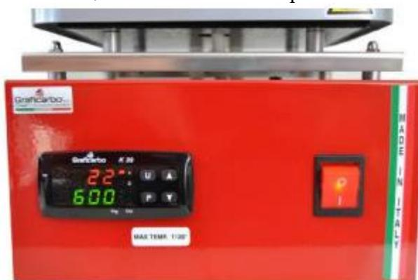
Пирометр автоматически включается, и текущая температура тигля отображается красным цветом в верхней части дисплея.
